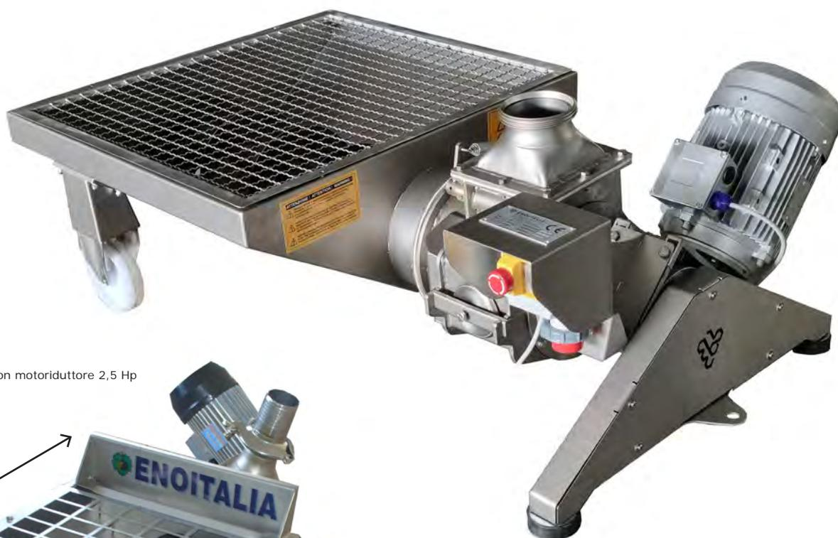
GAMMA 80 con motoriduttore 2,5 Hp
