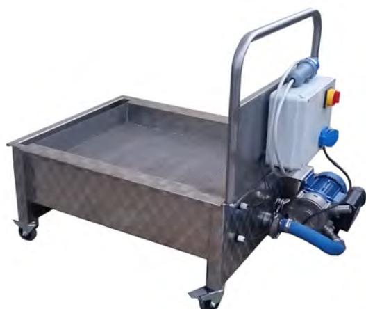
Vasca di raccolta costruita interamente in acciaio inox AISI 304, completa di griglia filtrante estraibile, idoneo per installazione sotto presse di spremitura, passatrici, o nelle operazioni di separazione dei vinaccioli.
