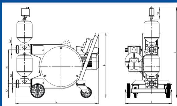
Tramoggia di alimentazione in acciaio inox Aisi 304, con coclea motorizzata e motoriduttore meccanico. Sistema di smontaggio rapido tra la tramoggia e la pompa con raccordo DIN. Presa elettrica indipendente per l'alimentazione della tramoggia dal quadro di comando della pompa. Ruota ausiliaria supporto tramoggia.
