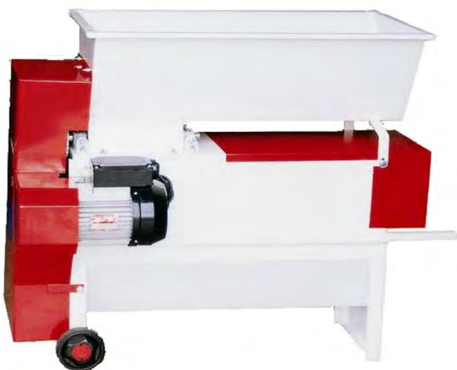
Le caratteristiche principali di questa macchina sono: l'impiego di una coppia a rulli (disponibili in alluminio alimentare e gomma alimentare), regolabili automaticamente con una molla in acciaio inox; l'utilizzo di serie di un vaglio e di una pompa centrifuga entrambi in acciaio inox; la possibilità di effettuare la sola operazione di pigiatura e diraspatura togliendo facilmente la vasca con pompa centrifuga.
