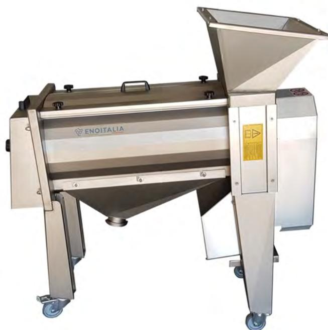
Una seconda postazione per la separazione tra la buccia esterna e gli arilli. Il macchinario è dotato di rulli in alluminio, coltelli di frantumazione e motore da 1,5kw.
