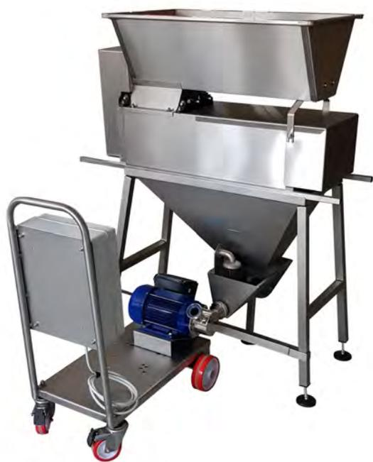
La linea semiautomatica per la lavorazione della melagrana è composta da una prima postazione di lavaggio e carico del prodotto all'interno della sgranatrice.
