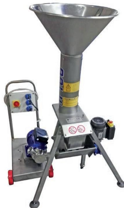
Pompa automatica per travaso polpa e succo: è composta da una vasca con coclea di dosaggio motorizzata ed una pompa volumetrica a girante flessibile. Si adatta perfettamente all'installazione sotto i mulini M100 oppure sotto le sgranatrici da frutta. Può essere dotata di sonde automatiche di livello per un funzionamento completamente automatico.
